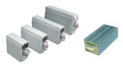
Elektronické předřadníky jsou určeny k zajištění funkce vysokotlakých sodíkových a halogenidových výbojek. Používají se bez dodatečného chladiče.
